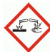
GHS 05 maró, korrozív
